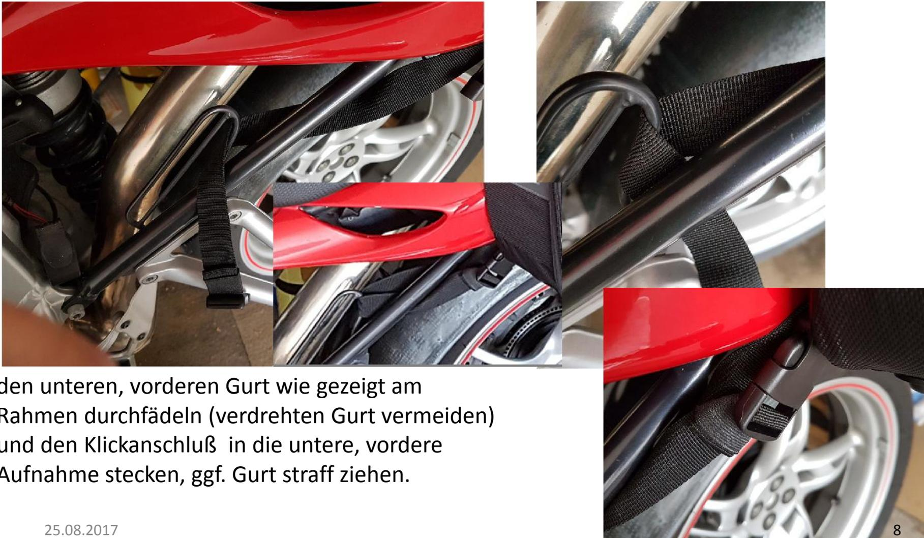
den unteren, vorderen Gurt wie gezeigt am Rahmen durchfädeln (verdrehten Gurt vermeiden) und den Klickanschluß in die untere, vordere Aufnahme stecken, ggf. Gurt straff ziehen.
