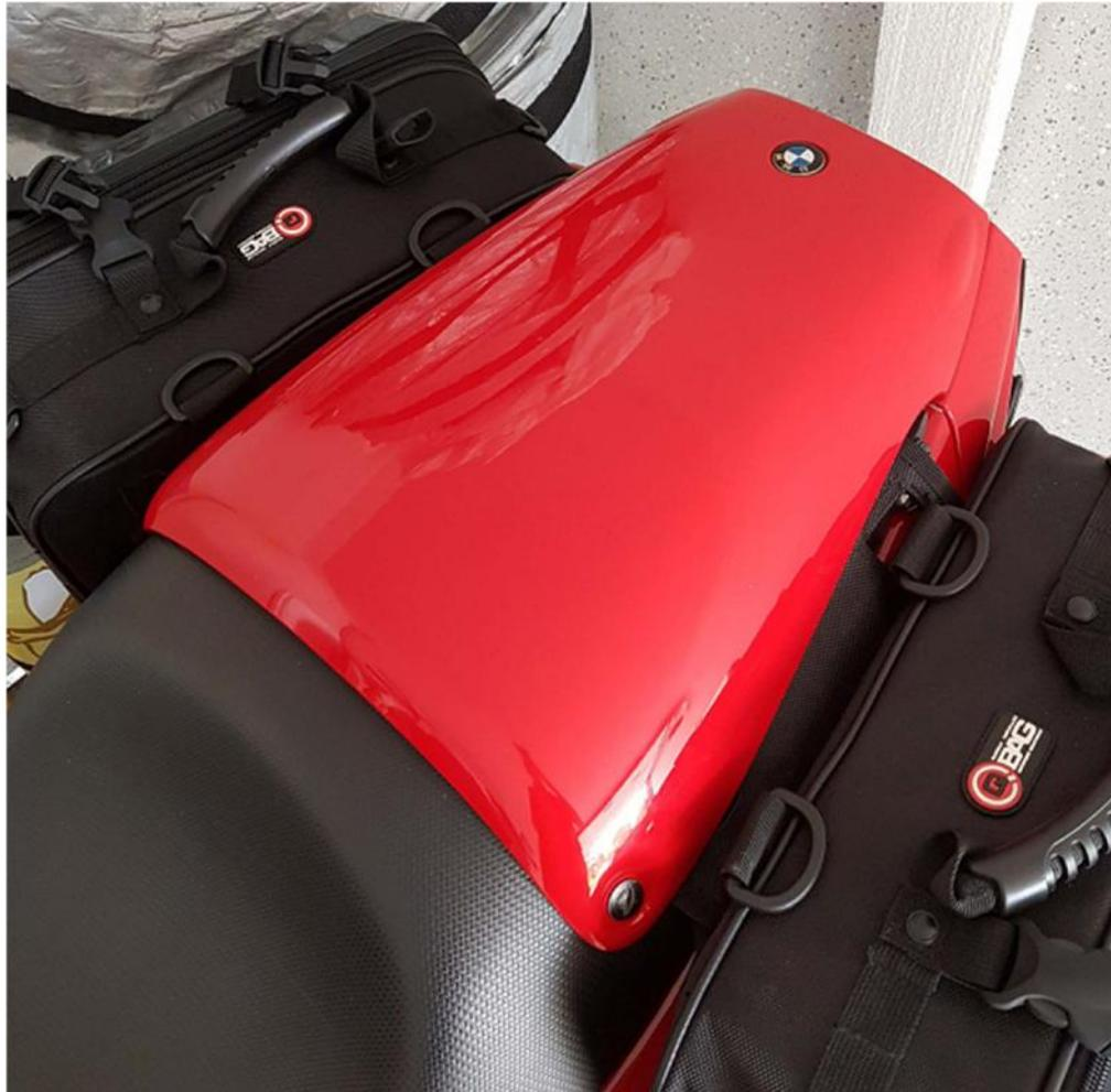
die Soziusabdeckung aufschieben und mit den beiden Schrauben befestigen. Drückt auf die Klettbrücke und sichert sie dadurch etwas.
