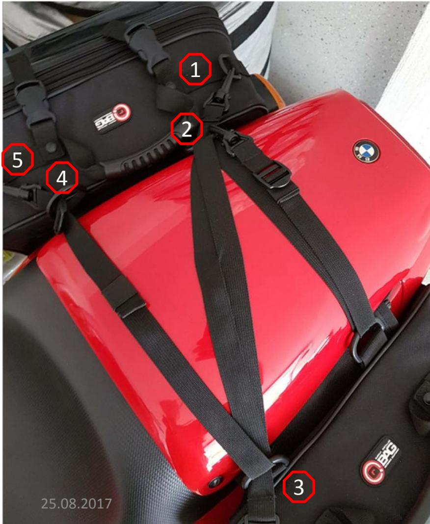
den 2. Trage-/Rucksackgurt an der Öse **1** auf der Satteltasche einhaken. Dann durch die Öse **2 + 3** an der Klettbrücke ziehen. Von Öse **3** aus über die Abdeckung zu Öse **4**. Hier durchziehen und zurück zu Öse **5**, dort einhaken.
