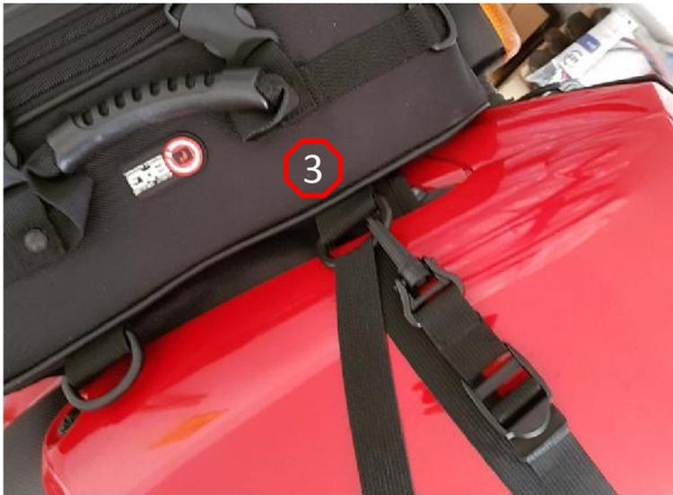
die Trage-/Rucksackgurte an der Öse **1** auf der Satteltasche einhaken. Dann durch die Öse **2 + 3** an der Klettbrücke ziehen. Von Öse **3** aus über die Abdeckung zu Öse **4**. Hier durchziehen und zurück zu Öse **3**, dort einhaken.
